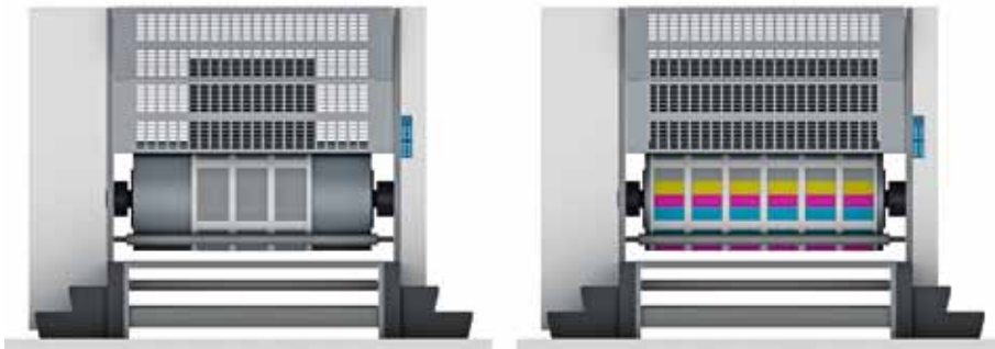
Alle Maschinen der KBA RotaJET-L-Serie basieren auf der gleichen Plattform und können auch nachträglich von Mono-Druck mit 777 mm Bahnbreite auf den 4C-Druck mit 1380 mm Bahnbreite aufgerüstet werden
